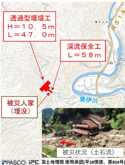
R3年7月12日の梅雨前線豪雨により、山腹が崩壊して土石流が発生し、人家の埋没や市道の通行止めなどの被害も生じたことから、更なる土砂災害に対して緊急的に対処するため、砂防堰堤や溪流保全工を実施中であり、R5年3月末時点で堰堤の床堀が完了しました。
