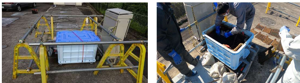
図 8 （左）小型化した装置一式、（右）鉄板交換の様子
