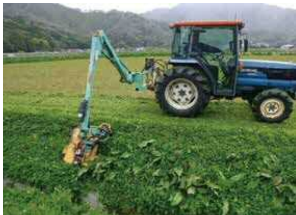
畦畔天端幅を拡幅(W=2m) トラクタ装着のアーム式モアによる機械除草
