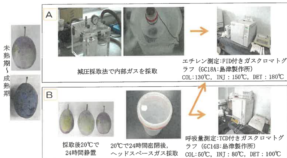
図2-1 樹上のブルーベリー果実における内部エチレン濃度 (A) と呼吸量およびエチレン生成量 (B) の測定方法 (2012年)
