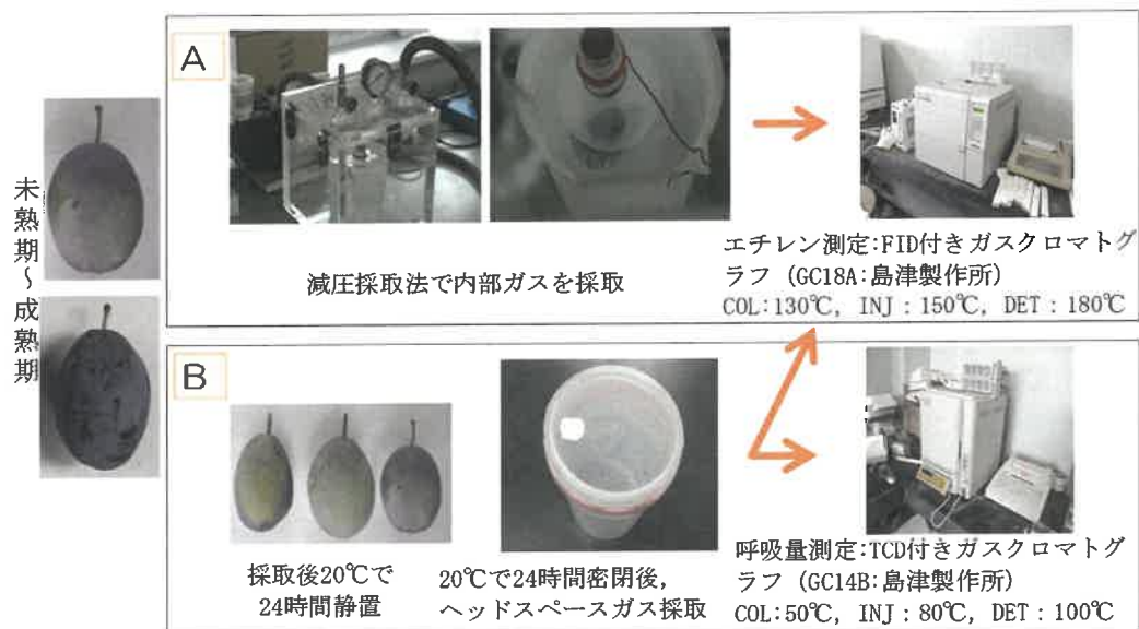
図2-1 樹上のプルーン果実における内部エチレン濃度 (A) と呼吸量およびエチレン生成量 (B) の測定方法 (2012年)
