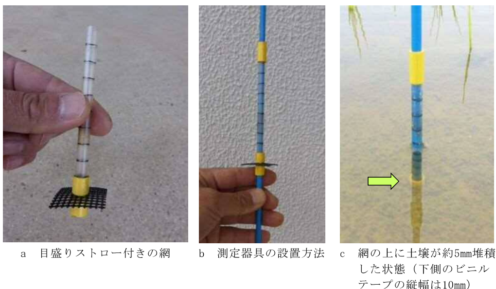
図7 目盛り付きの土壌堆積深測定器具
