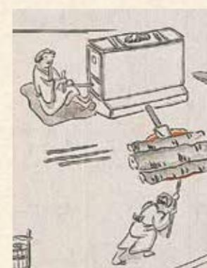
O “chumbo nobre” era colocado sobre uma camada de carvão e aquecido até derreter, de modo que apenas o chumbo escorria, se misturando ao carvão, enquanto a prata permanecia na superfície. Depois, repetia-se o processo para aumentar a pureza da prata.
