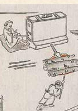
將貴鉛放在「灰吹床」上加熱溶解，把鉛染進灰中，進行分離，讓灰上只留下銀。之後再進行同樣的作業，提升灰吹銀的純度。
