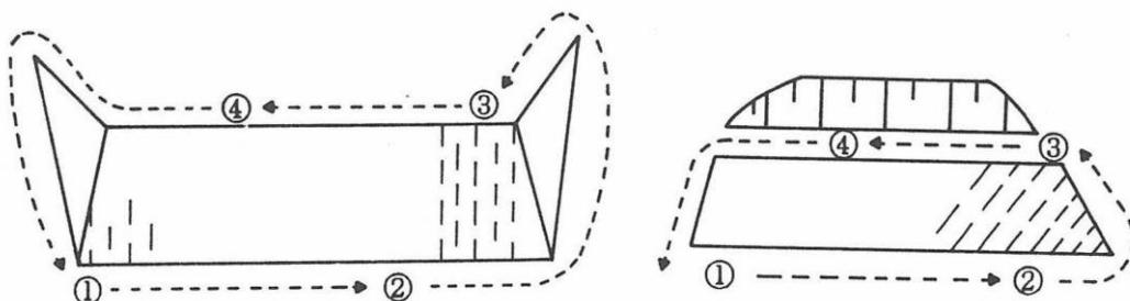
図 2-1 擁壁の被害状況調査経路
