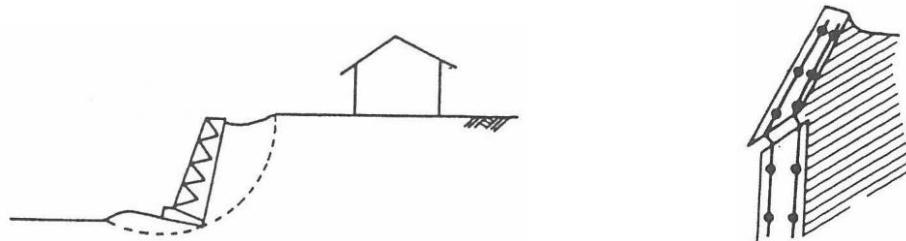
(a) 擁壁基礎の崩壊 (b) 壁体の斜めせん断による折損
