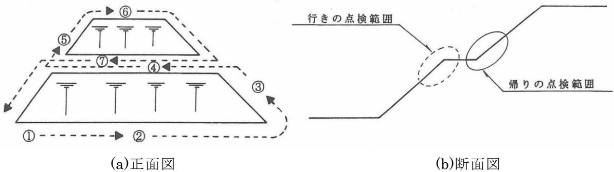
図 2-2 のり面の被害状況調査経路
