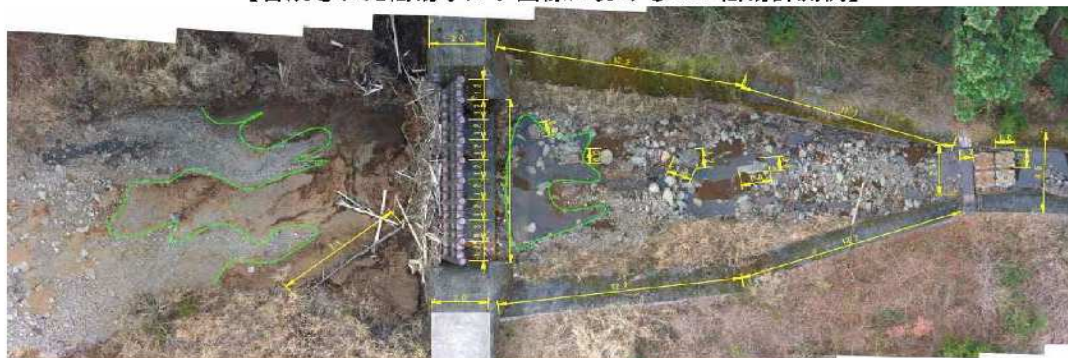
【合成された簡易オルソ画像における CAD 簡易計測例】
