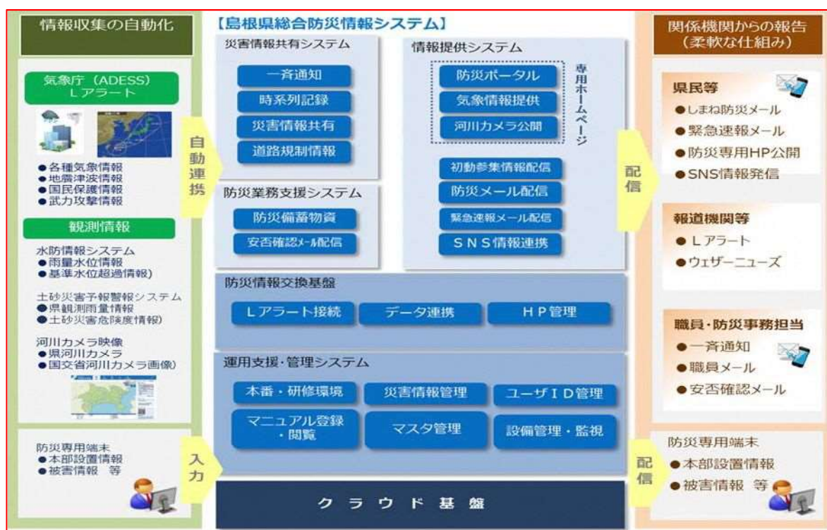
図-7.3.1 島根県総合防災情報システム全体イメージ
