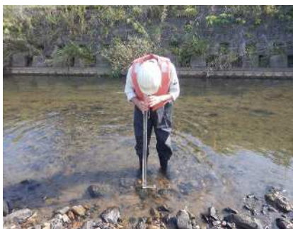
透視度の測定 (現地測定)
