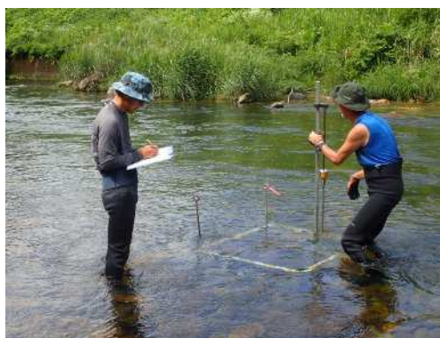
河床硬度の測定 測定器:長谷川式土壌貫入計
