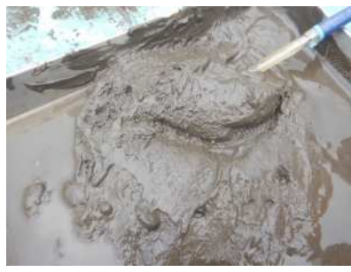
ORPの測定 (採泥後、現地測定)
