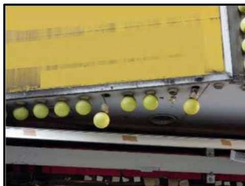
ソケットの破損
