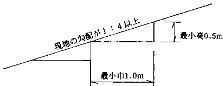
図1-2-1 盛土基礎地盤の段切
