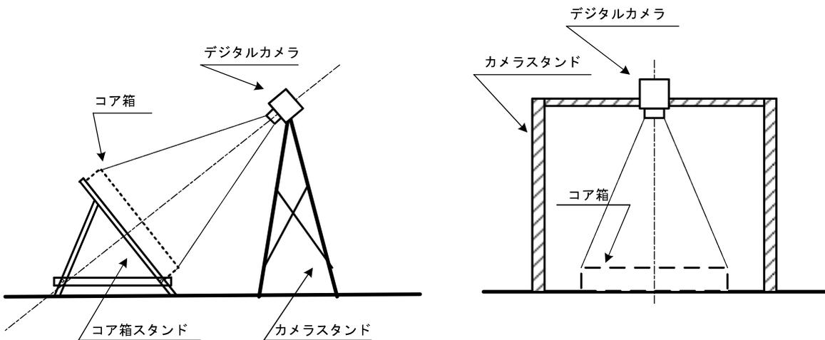
図 8-2 ボーリングコア写真の撮影方法例
