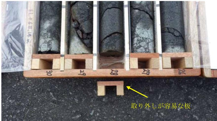
写真 10-3 箱右端伸びしろへの板の挿入例
