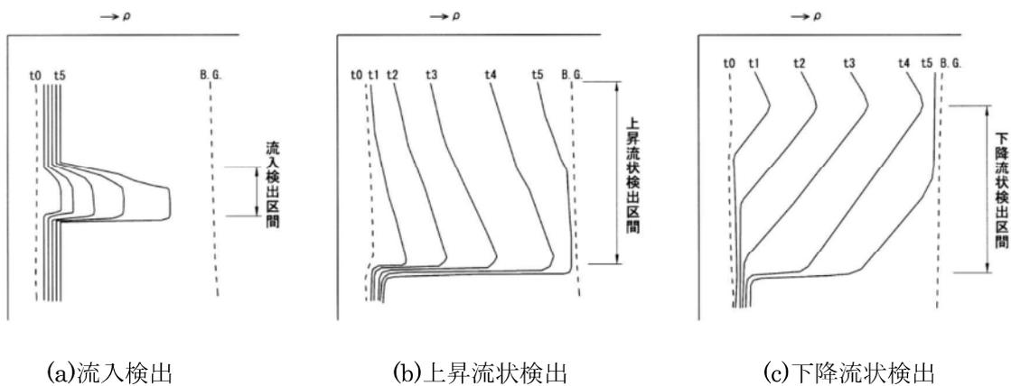
図 7-4 地下水検層結果の判定
