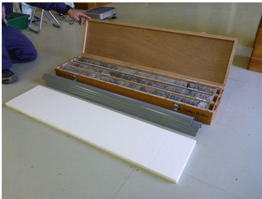
写真 10-14 保護材を取り外した状態
