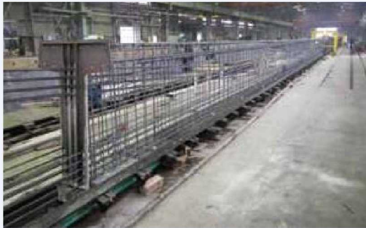
プレテンションT桁 (JIS A 5373)
