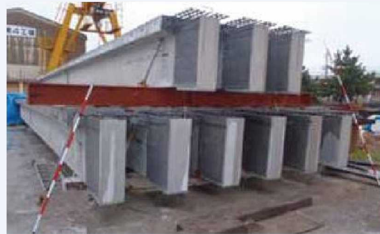
プレテンションT桁 (JIS A 5373)
