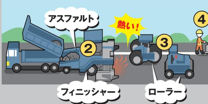
舗装工事とは、道路に砕石を敷いて押し固め、その表面にアスファルトを敷き詰める工事のことだよ！
