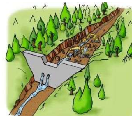
次の出水による土石流に備えて土砂を撤去
