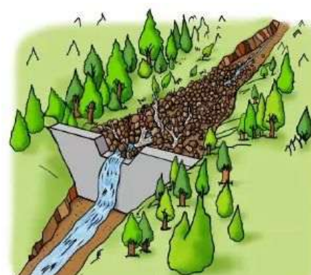
大雨等の出水等で砂防堰堤の堆砂敷が満砂
