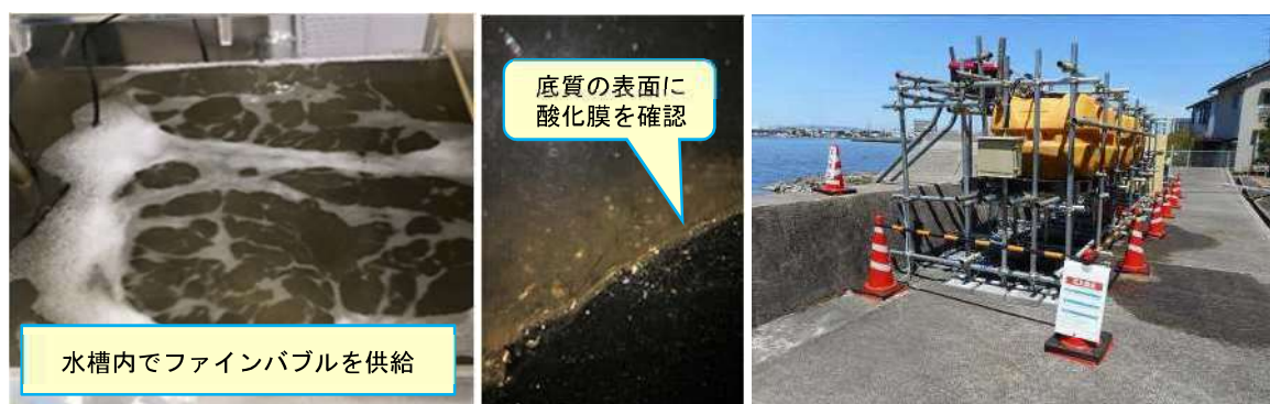
図6 ファインバブルの実験状況（左）と処理後の底質（中）及び実証試験の様子（右）
