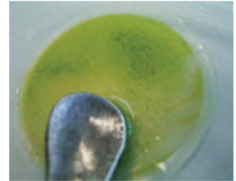
フィルターの上をろ過されたものを薬品さじで洗い流しているようす
