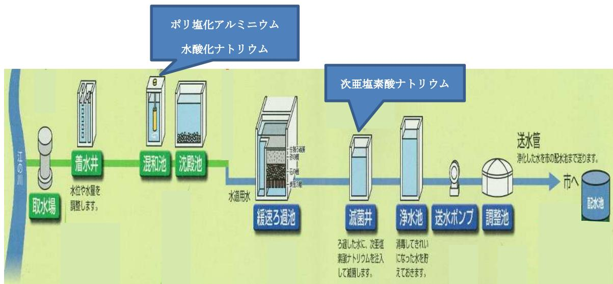
※今津浄水場と三代浄水場は河床下の伏流水を取水しています。このため、今津浄水場には取水場、混合池、沈殿池が、三代浄水場には混合池、沈殿池がありません。
