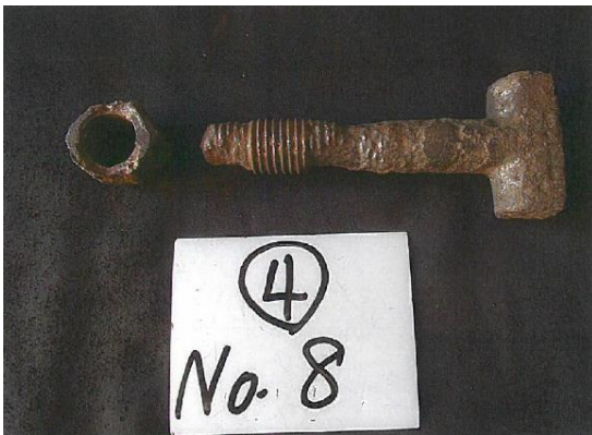
[ボルト・ナットの腐食状況]
