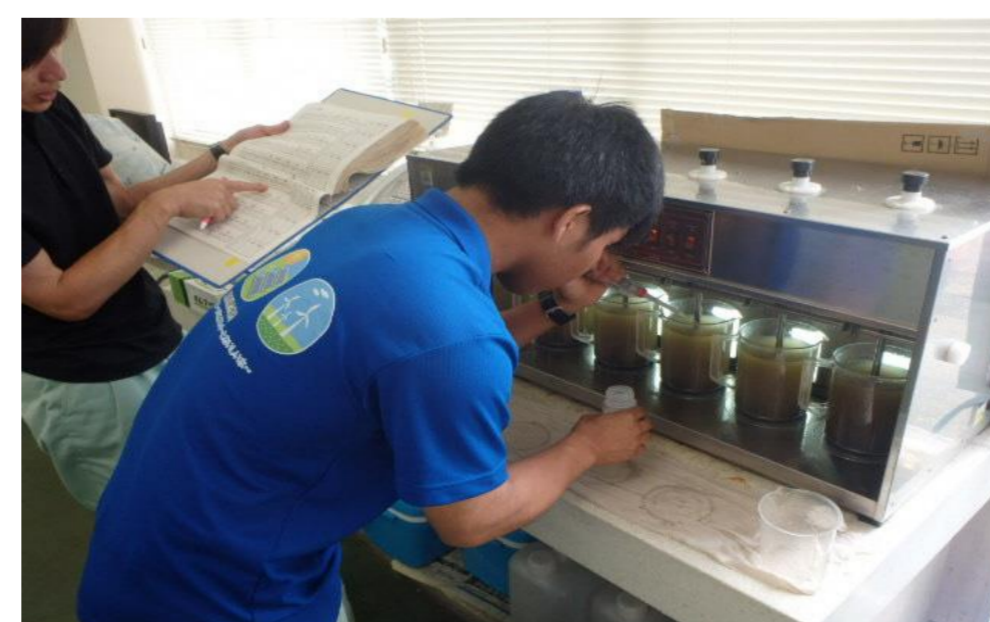
危機管理訓練（江津浄水場：高濁度）
