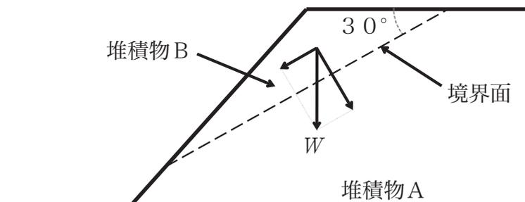
堆積物Bの総重量を $W$ とすれば、堆積物Bが境界面に沿ってすべり落ちようとする力は $W \times$ 〔ア〕である。一方、堆積物Aから、堆積物Bへの垂直抗力は $W \times$ 〔イ〕である。境界面に粘着力がないと仮定した場合、前者と後者の大きさの比が〔ウ〕より大きい場合にすべりが発生することとなる。上記の場合に前者と後者の大きさの比を計算するとおおよそ〔エ〕となる。
