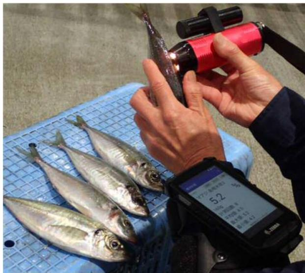
図1 新たな脂質測定器による測定
