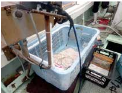
2) 漁船をアイドリング状態に設定 3) 浮標を外し、ラインホーラーにより道糸を巻き揚げ、カゴCの内部に収納
