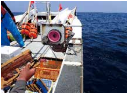
2) 漁船をアイドリング状態に設定 3) 浮標を外し、ラインホーラーにより道糸を巻き揚げた
