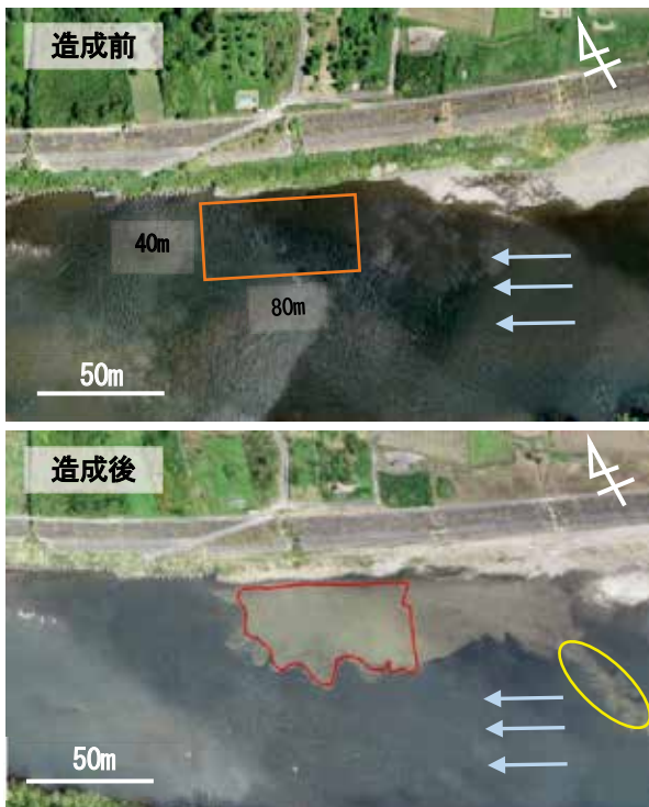
図3. 2024年の産卵場造成前(上)と造成後(下)の長良の瀬 水色の矢印は流向を, 橙色線で囲まれた部分(上)は造成予定範囲(3,200m 2 )を, 赤色線(下)は造成範囲(2,578m 2 )を, 黄色線(下)は簡易的な導流堤を造った場所を示す。
