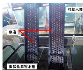
図1 プレート型魚道 図2 実験の様子
