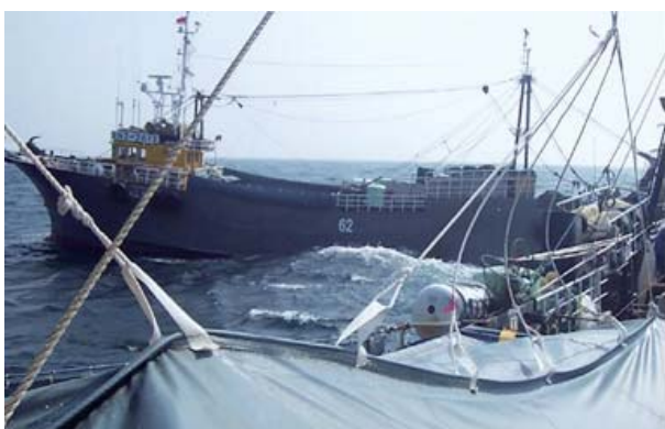
図1 乗船調査した船。浜田の沖底は2隻の船で1つの網を曳きます。
