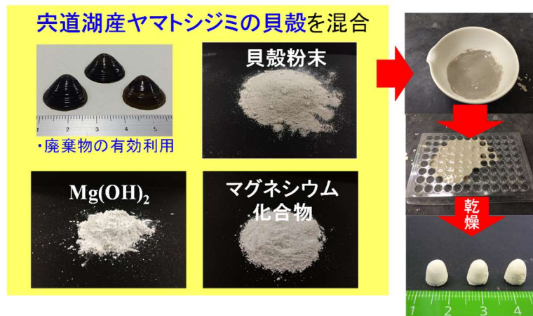
図 14 硫化水素発生抑制剤の製作フロー
