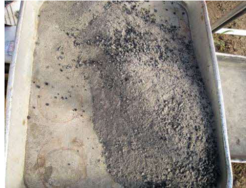
木質ペレットの燃焼灰
