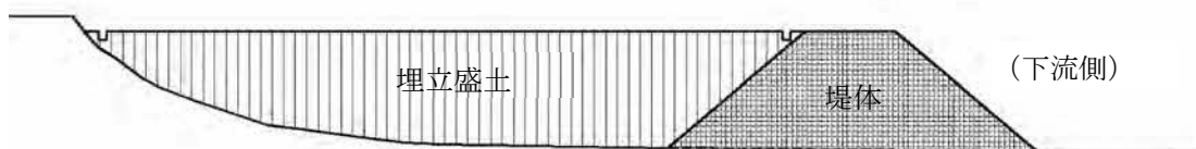
図-3.3 埋立工法（縦断イメージ）
