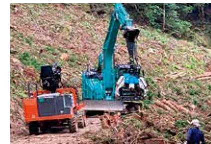
R2導入の新型フォワード。令和のリョウシン号第1号機。後ろにはリース機のプロセッサー。このセットで1日40~50m<sup>3</sup>造材、搬出しています。
