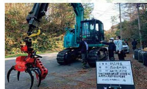
R2導入したロングリーチ伐倒ソー。(15m,最大伐倒径60cm)
