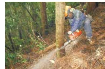
チェンソーによる伐倒作業
