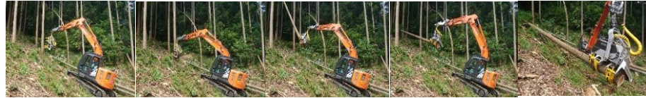
高性能林業機械による伐採作業【可能な限り、高性能林業機械による伐採・造材・地拵え作業を実施】
