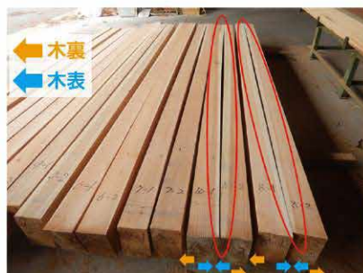
■製材後の縦反りの様子（木裏側に凸）
