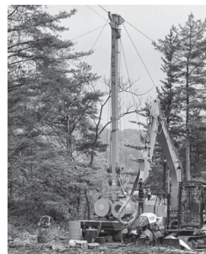
最新のタワーヤードによる集材
