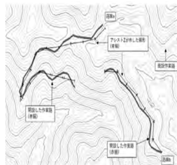
■ 人力設計（太線）と機械設計（細線）の比較（津和野町）
