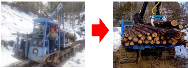
3tフォワーダ 6tフォワーダ フォワーダでの運材作業状況
