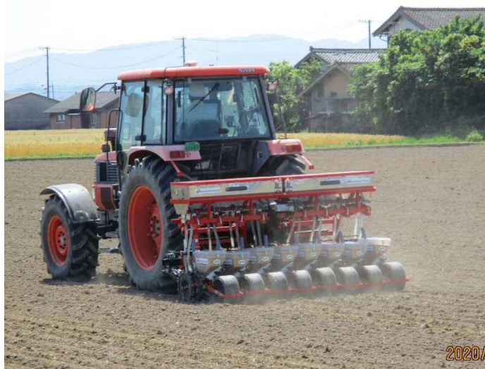
写真1 播種作業中の高速高精度汎用型播種機
