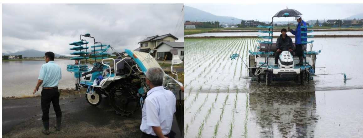
苗載せ台の上にGPS受信部設置
