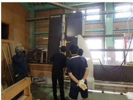
パネルソーを使用したスギ板の切断作業
