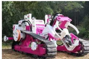
〈遠隔操作式伐倒機〉
