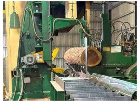
〈製材用丸太の加工〉
