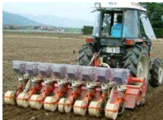
第1図 碎土・播種・施肥同時作業機
