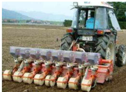
第1図 碎土・播種・施肥同時作業機
