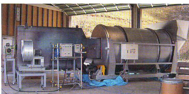
写真1 製作後の加熱搅拌装置
