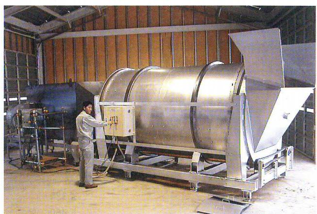
写真2 加熱搅拌装置の運転
