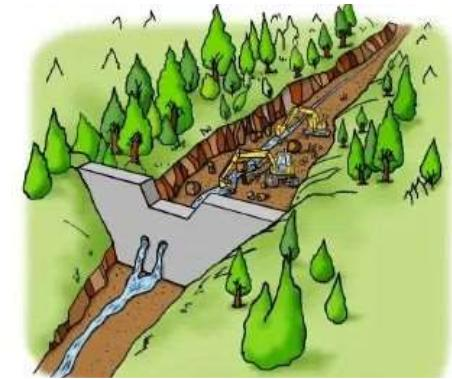
次の出水による土石流に備えて土砂を撤去
