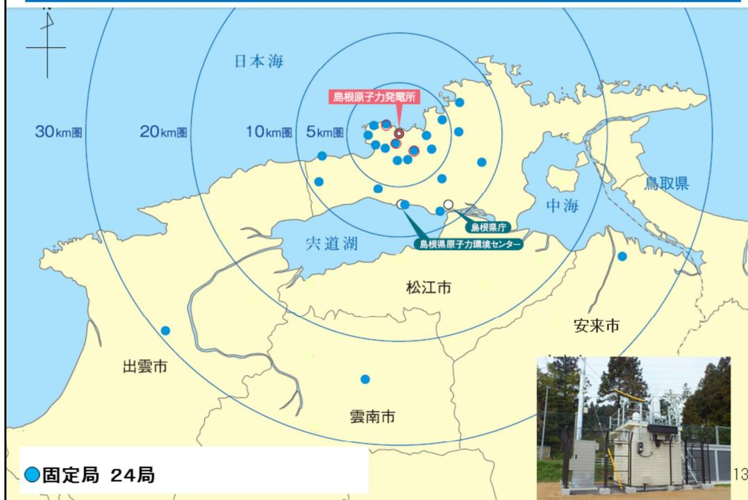
県は、島根原子力発電所周辺の空間放射線量率を平常時から連続測定し、異常の有無を監視するため、モニタリングポストを24地点に設置しています。
