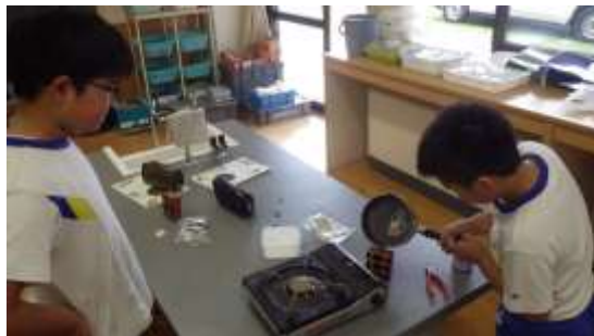
溶けた金属を慎重に鑄型に流し込みます
