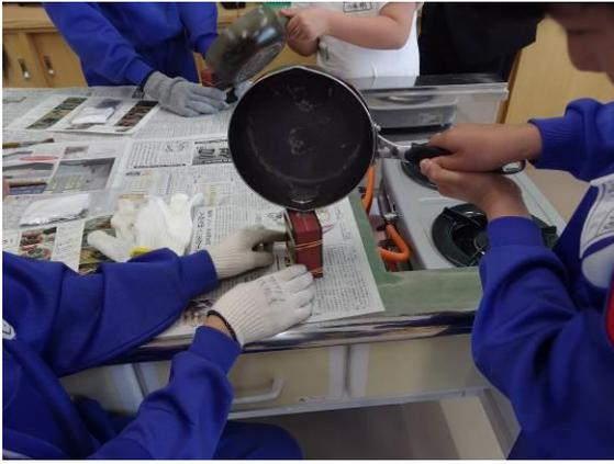
金属がドドロロに溶けたら鑄型に流し込みます
